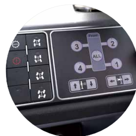
Steering control panel 转向控制面板
