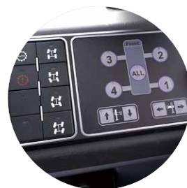
Steering control panel 转向控制面板
