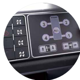
Steering control panel 转向控制面板
